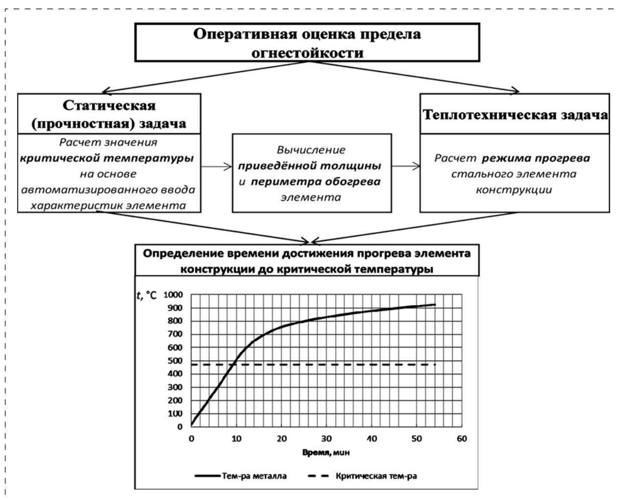
Рис. 1. Обобщенная схема расчета предела огнестойкости металлического элемента строительной конструкции
