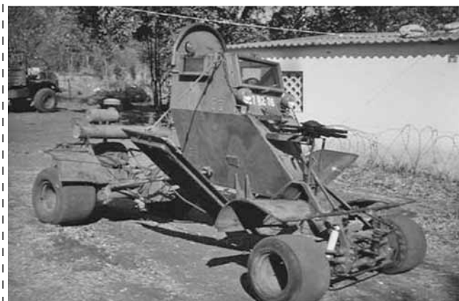
Рис. 2. Машина с миноискателем Пуки (Pookie)
