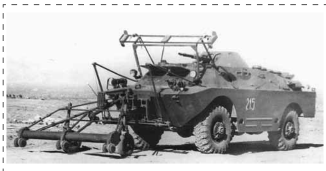
Рис. 4. Миноискатель ДИМ-М на базе бронетранспортера БРДМ
