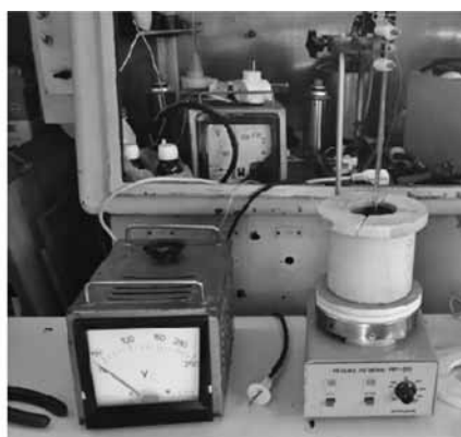
Рис. 2. Вид экспериментальной установки по определению температуры самовозгорания образцов лесных горючих материалов:
