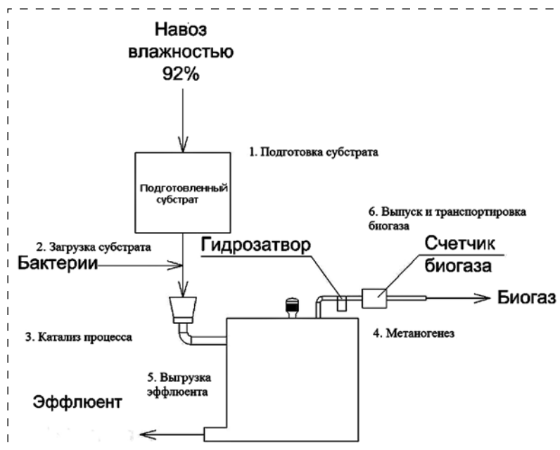
Рис. 1. Технологическая схема получения эффлюента при анаэробном сбраживании органических отходов сельского хозяйства
